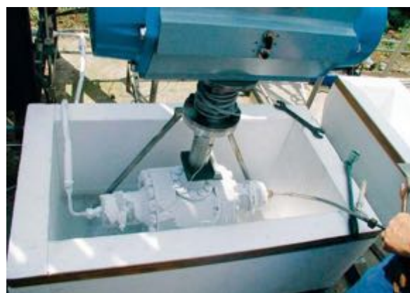
Криогенное испытание – шаровой кран NPS 4" CLASS 600 / Cryogenic testing – ball valve NPS 4" CLASS 600
